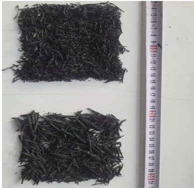
Sợi thép tái chế từ cấu trúc lốp, được dùng như vật liệu gia cường bổ sung.
