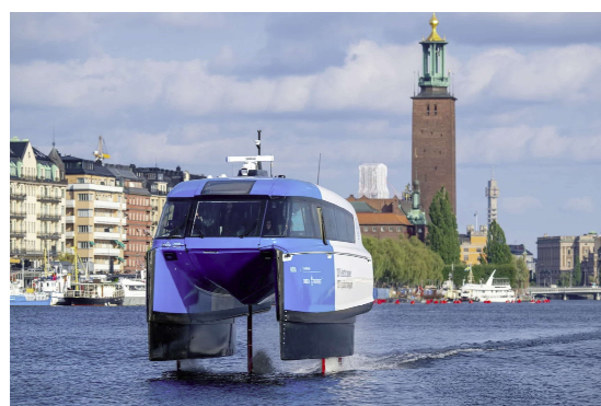
Một chiếc phà cánh ngầm chạy bằng điện màu xanh và trắng được nâng lên khỏi mặt nước khi nó di chuyển qua bờ sông của thành phố (Nguồn: Candela)
