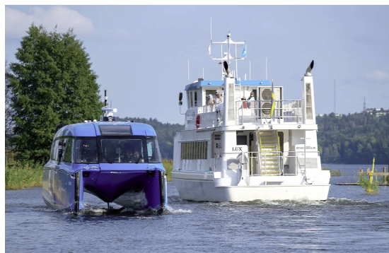
Phà cánh ngầm điện chỉ sử dụng một phần rất nhỏ lượng khí thải nhà kính so với tàu thuyền thông thường (Nguồn: Candela)
