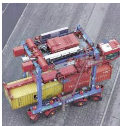
Xe nâng chuyên dụng tại cảng dual-fuel straddle carrier.
