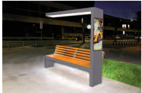
Băng ghế thông minh trên một đường phố Moskva, có thể điều hướng, được trang bị đèn LED, wifi và sạc thiết bị di động.
