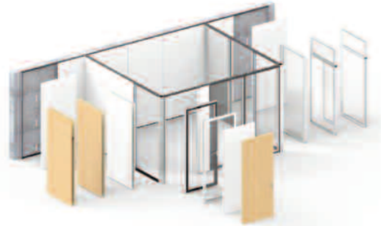
Mô tả thi công lắp ráp trang trí tiên chế.
