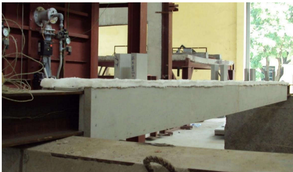
Hình 36 – Bọc bảo vệ chịu lửa cho mẫu dầm thép tiết diện I bằng tấm Silicate (trước khi TN)
