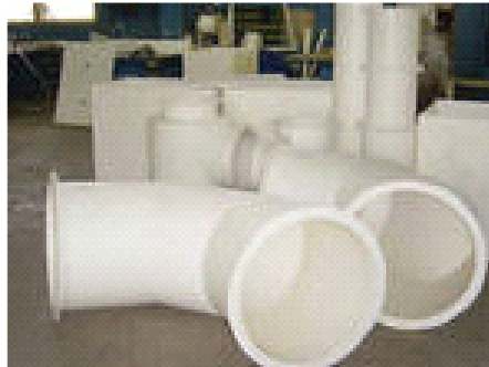
Ống gió bằng vật liệu polime nửa mềm các tiết diện khác nhau
