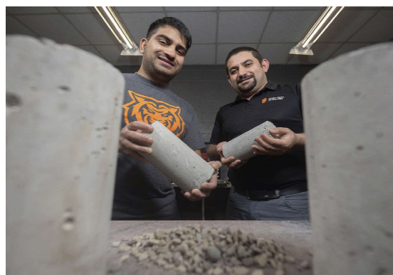
Bê tông có thể được làm từ chất thải sau quá trình sản xuất đường.
