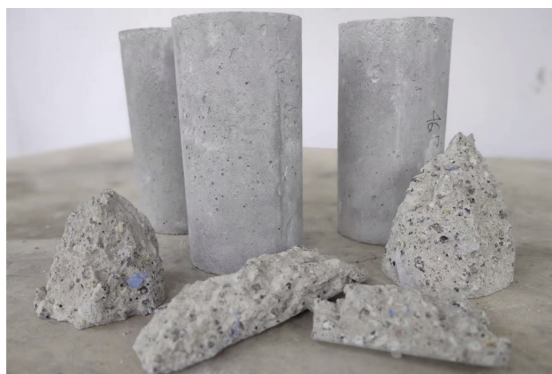
Các nhà khoa học RMIT đã phát triển bê tông với nhựa PPE vụn để tăng cường độ bền.
