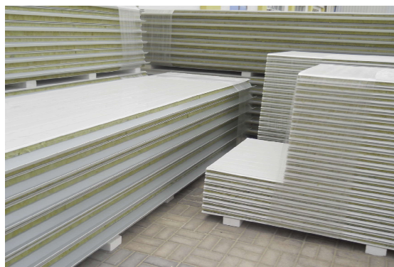
Panel 3 lớp với lớp lõi cách nhiệt từ bọt polyurethane được sản xuất tại một nhà máy ở ngoại ô St.Peterburg.
