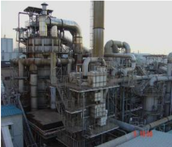
Ảnh 6,7: Lò đốt bùn và màn hình theo dõi nhiệt độ trong lò tại trạm XLNT Tsumori
