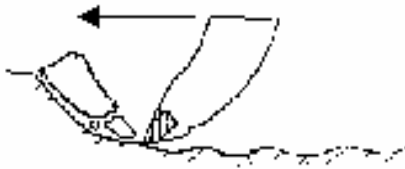
Hình 1. Tác động cắt của răng cắt (Speight 1997)
