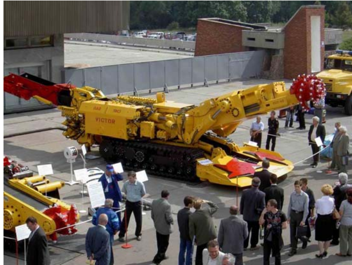
Hình16. Combai KSP-43 (phiên bản cải tiến của KSP-42) của Yasinovatsky Machine Building Plant (Ukraine)
