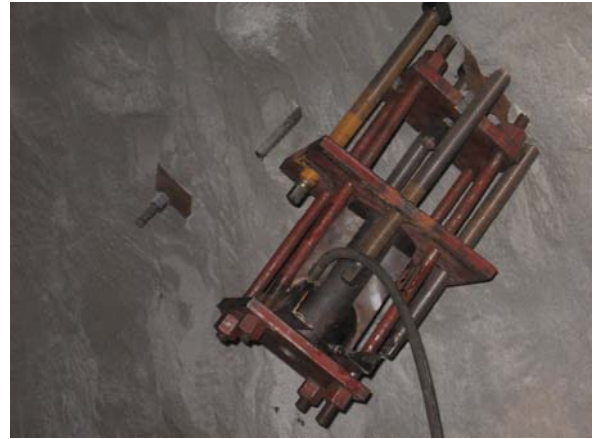
Hình 16. Thử tải neo chất dẻo
