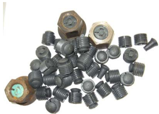
Hình 18. Chốt nhựa và đai ốc neo chất dẻo tự sản xuất
