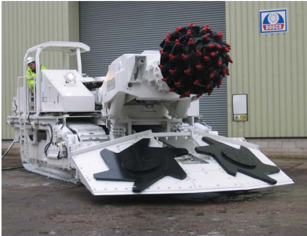
Hình 1. Combai MK-4 (Doso – Anh) với khả năng cắt hiệu quả trong đá có UCS lên tới 130 MPa
